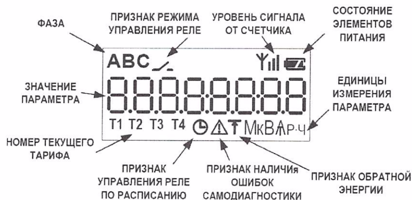
Рисунок 1 – Внешний вид и назначение сегментов индикатора дисплея
